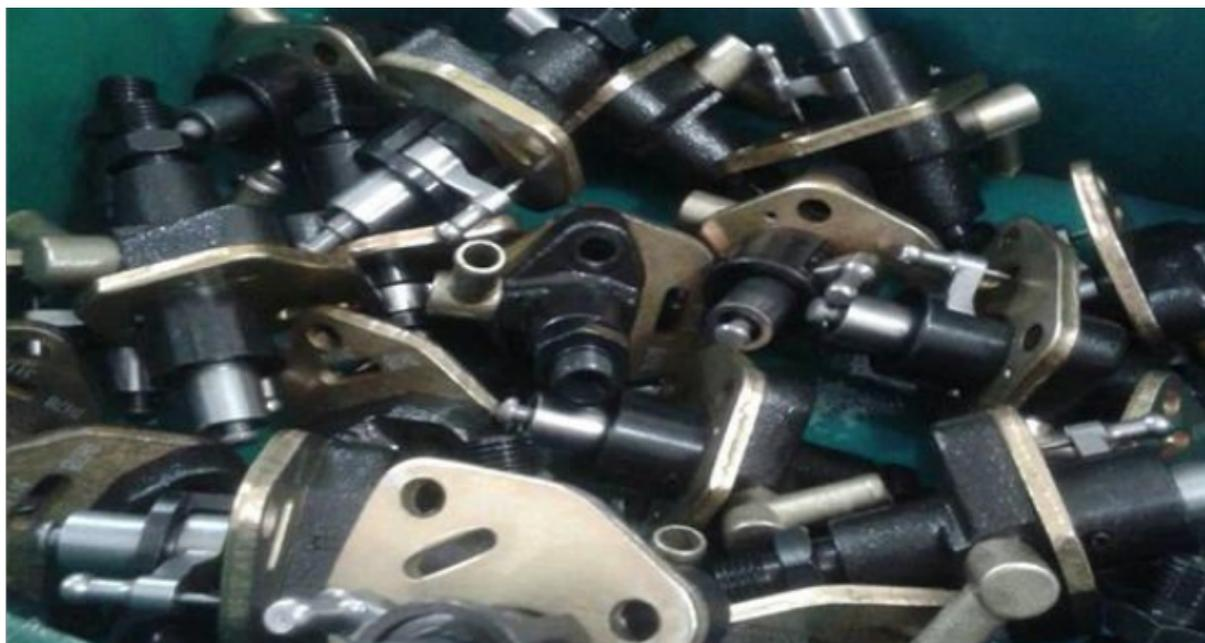
看颜色某些原厂配件表面指定某种颜色，若遇其他颜色，则为假冒伪劣零配件；3、看外表原厂配件外表印字或铸字及标记清晰正规，而假冒产品外观粗糙；4、看油漆不法商人将废旧配件经简单加工，如拆、装、拼、凑、刷漆等处理，再冒充合格品出售，非法获取高额利润；5、看质地原厂配件的材料是按设计要求采用合格材料，假冒产品多是采用廉价低劣材料代用；6、看工艺低劣产品外观有时虽然不错，但由于制作工艺差，容易出现裂纹、砂孔、夹渣、毛刺或碰伤；7、看“储存”汽车配件如果出现干裂、氧化、变色或老化等问题，可能是在存放当中环境差、储存时间长、材料本身差等原因造成的；8、看“接合”如果发生离合器片铆钉松脱、刹车皮管脱胶、电器零件接头脱焊、纸质滤芯接缝处脱开等现象，则不能使用；9、看标识部分正规的零部件上标有某些记号，比如时齿轮记号、活塞顶部标记等装配标记，用来保证机件正确安装，没有的不能购买；10、看缺漏正规的总成部件必须齐全完好，才能保证顺利装车和正常运行。一些总成件上的个别小零件漏装，一般是“”，这些给装车造成困难。往往因个别小配件短缺，造成整个总成部件报废。
